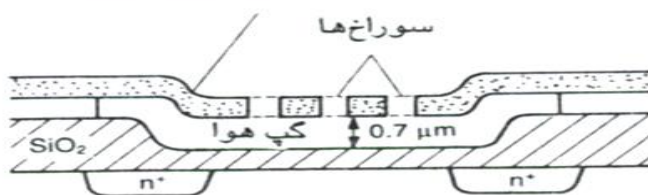
شکل ۸۱۰ GasFET با شبکه Pt معلق شده بالای گیت [۳۳۱].
